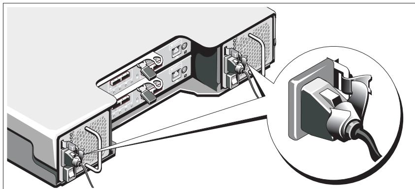
Ikatkan kabel dengan kencang pada braket dengan menggunakan strap yang disediakan.
