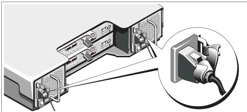
使用提供的束带将电缆牢牢地固定在支架上。
